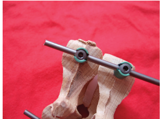
Рисунок 7 - Разрушение внутренних граней стопорной гайки и головки винта фиксаторов других фирм-производителей, имеющих форму шестигранника, при демонтаже системы
